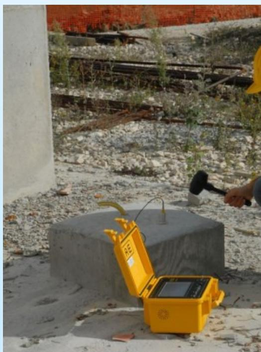
L'echo test sonico è un metodo d'indagine basato sulla misura della velocità di riflessione delle onde di compressione, per verificare l'integrità e la profondità di un palo.
