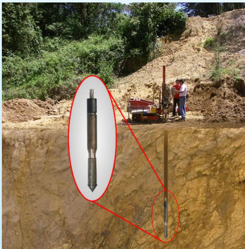
Oltre alle prove di tipo dinamico (DPSH) e di tipo statico (CPT), la **silpa** è in grado di eseguire anche le prove con punta elettrica (CPE) e con piezocono (CPTU).
