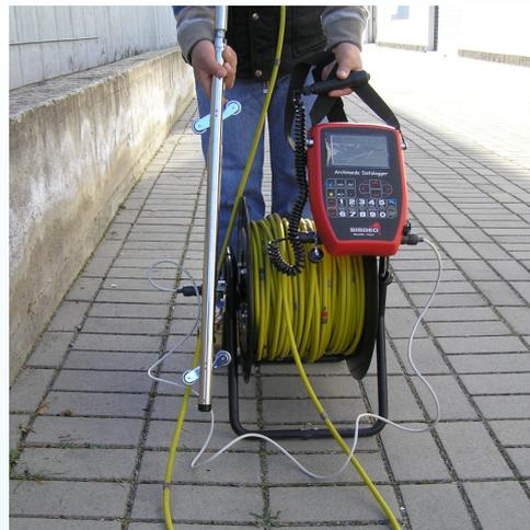
Le sonde inclinometriche effettuano controlli della deviazione laterale di un tubo interrato; sono impiegate nel monitoraggio dei movimenti franosi, dei versanti instabili, dei muri di sostegno.
