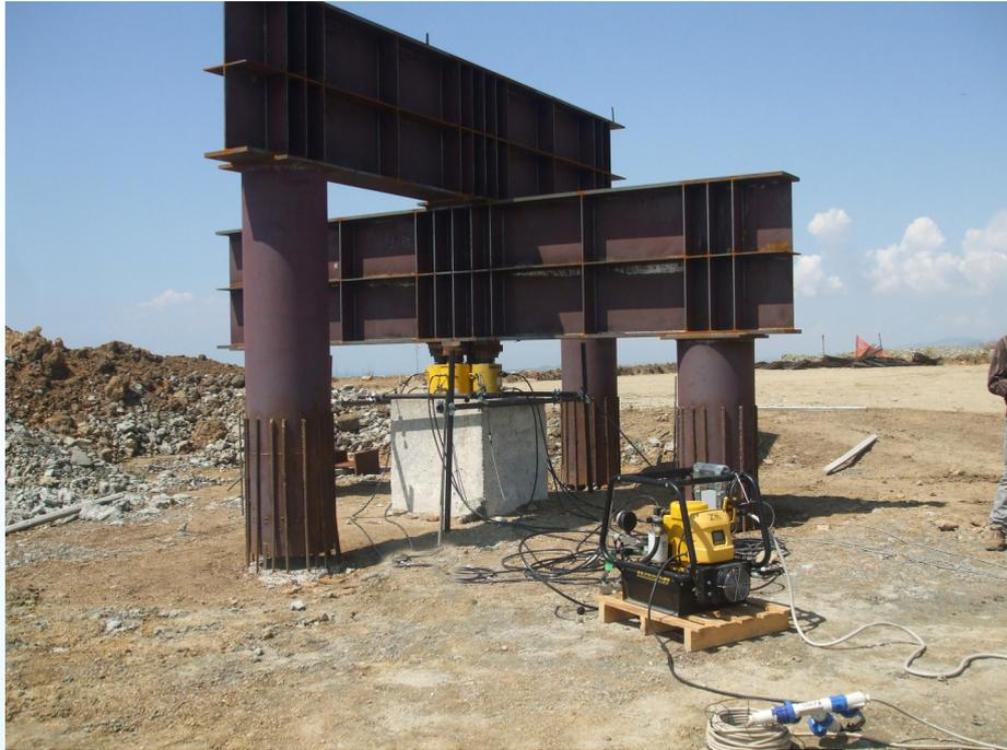
Allo scopo di verificare il comportamento dei pali sotto le azioni di progetto, la **silpa** è in grado di eseguire prove di carico fino al valore di 10.000 kN.
