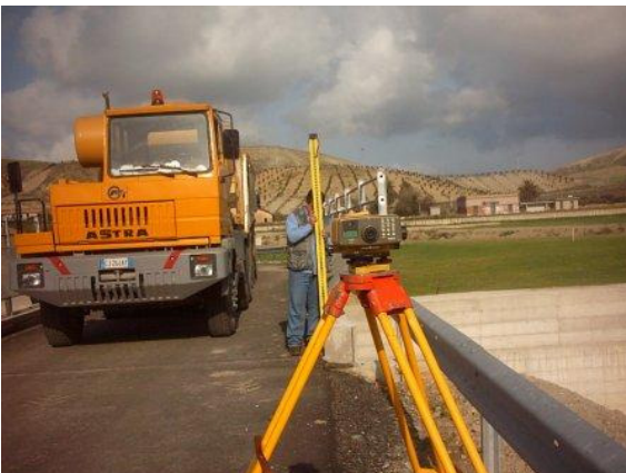
Prove di carico su ponte mediante livellazione
