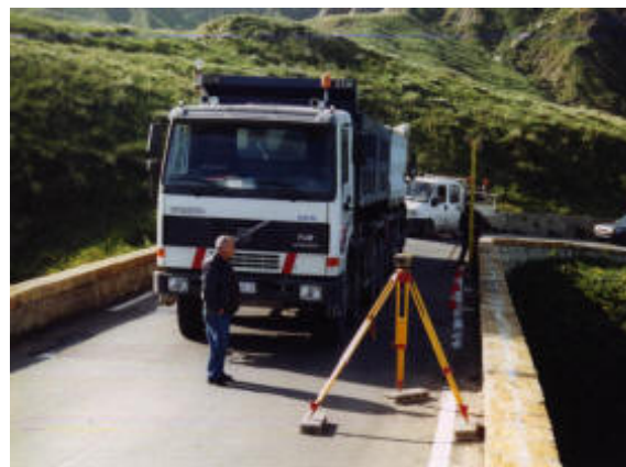
Prove di carico su ponte mediante livellazione
